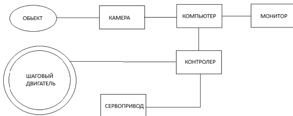
Рисунок 1 – Блок-схема многофункциональной машины по определению показателей качества яиц и автоматической сортировки на категории
