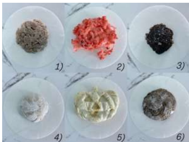
Рисунок 3 — Образцы композитных материалов на основе PS-6: 1 — PS-6 + гипсовая шпаклевка; 2 — PS-6 + мел; 3 — PS-6 + песок; 4 — PS-6 + гипсовая шпаклевка + воск; 5 — PS-6 + мел + воск; 6 — PS-6 + песок + воск.
