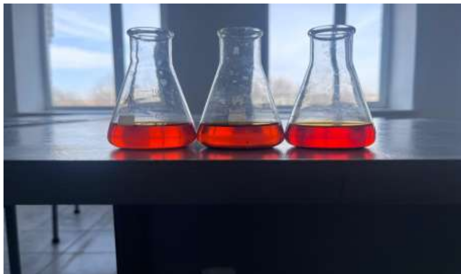
Рисунок 3 - Растворы с метиловым оранжевым и цеолитами после 24 часов 1 — каолиновая глина + каменный уголь 50:50; 2 — каолиновая глина + каменный уголь 80:20; 3 — каолиновая глина + каменный уголь 80:20;
