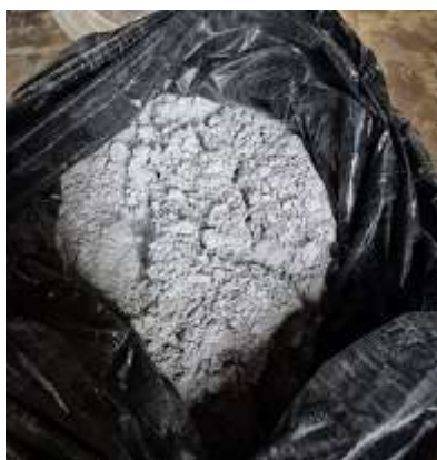
Рисунок 1 – Сырьевая смесь бесцементного вяжущего после совместного помола компонентов
