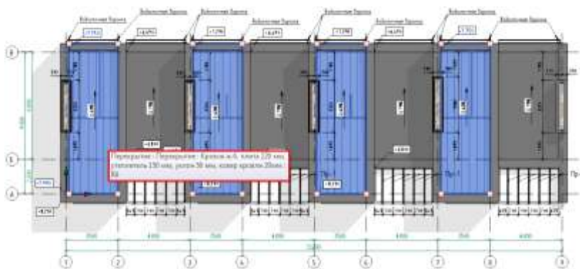
Рисунок 2 - Вариант проектного решения крыши малоэтажного жилого объекта в формате 2D-представления (чертежа графической части проекта)
