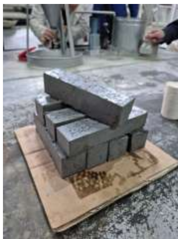
Рисунок 2 – Образцы раствора на основе бесцементного вяжущего после твердения
