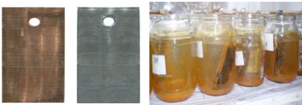
Сурет 2- Минералды тыңайтқыш ерітінділеріндегі қорғаушы жабынмен қапталған пластиналар
