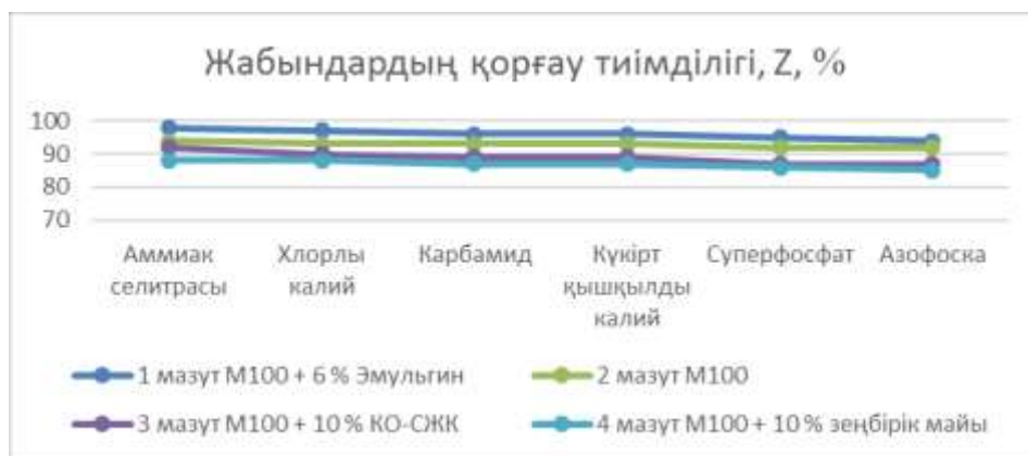
Сурет 3- Минералды тыңайтқыштардың концентрацияланған ерітінділеріндегі 8кп болатты мазут М100 + қорғаушы құрамдарымен қорғау дәрежесі Z, %
