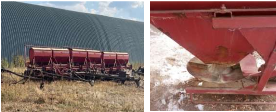
Сурет 1- Маусым аралық кезеңдегі ауылшаруашылық техникаларын сақтау жағдайлары және олардың коррозиялық бұзылуы
