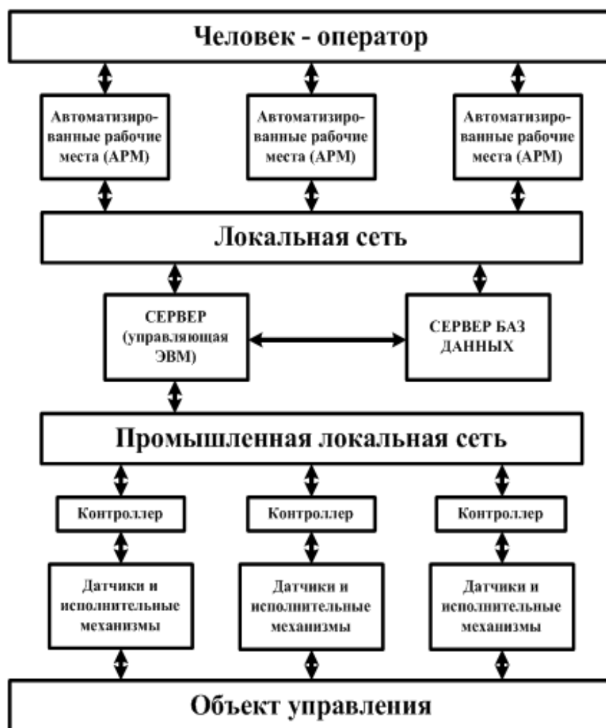
Рисунок 1- Структура АСУ ТП
