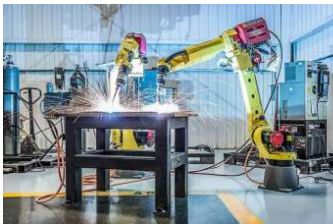
Рисунок 1 - Роботизированная установка для дуговой сварки FANUC [3].
