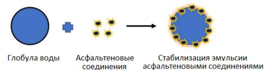
Рисунок 1 - Механизм стабилизации эмульсии асфальтеновыми соединениями; последние образуют тонкий слой вокруг диспергированной капли воды для обеспечения стерической стабилизации эмульсии.
