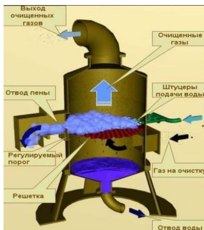
Рисунок 4 - Пенный скруббер.
