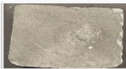
Сурет 3 – 40x50x10 қалыпта құйылған бор-гипс-күл қоспасының үлгісі
