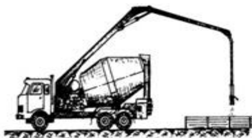
Рисунок 3 - Автобетононасос с бетоносмесителем
